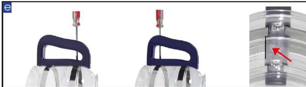
6mm プラスドライバーを使って、まず上側のねじを仮止めします。（軽く締めておく程度にしてください。）下側のねじも緩めに取り付けます。取っ手の右端が黒い基準線と重なるように調整します。取っ手の右端が黒い基準線にそって、真っ直ぐになった状態を確認してから両方のねじを完全に締めてください。
