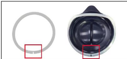
蓋を裏返して、パッキンの溝がある面を下向きの状態（ふたの縁側）にして装着します。パッキンの切り口は蓋の三角形カバーの反対側の位置にくるように装着してください。切り口は蒸留水が溜まる際の空気抜きになります。
