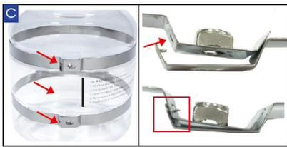
2本の帯をガラス容器に巻き付ける際、ナット（ねじ受け）の向きをラベル上の黒い基準線に合わせながら、図のようにねじ穴右側の四角い穴にもう一方の片端のフックをひっかけて二重に固定します。
